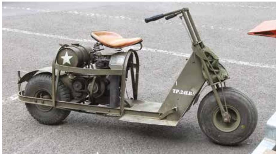
Ce scooter Cushman M53, produit en 1944-45 à l'usage des parachutistes américains, est équipé d'un moteur de 250 cm<sup>3</sup> et donc de ce fait soumis au contrôle technique. Quelle va être la réaction du contrôleur devant cet engin démuné d'éclairage, d'avertisseur sonore, de rétroviseur, de suspensions et ne disposant que d'un frein à pied ?
