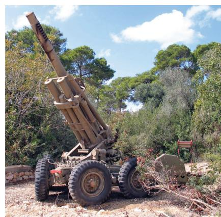
📍 Obusier de 155 mm, modèle 1950/63 est monté sur affût biflèche pouvant s'ouvrir pour la stabilité. Pneumatiques increvables. Frein de bouche à ouïes et à recul variable pour effectuer le tir plongeant et le tir vertical. Fabriqué à 980 exemplaires, il a été pendant longtemps le matériel d'artillerie majeur des divisions d'infanterie. Il est classé en catégorie A et le canon doit être neutralisé.
